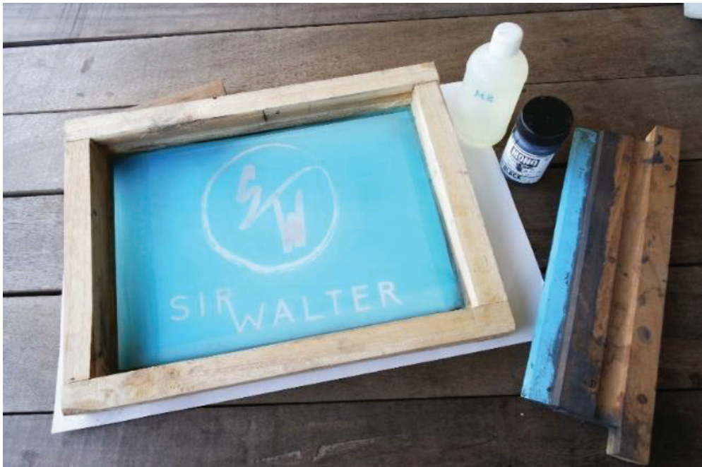
Gambar 2.26 Alat dan bahan serta hasil sablon pada kantong kertas.
